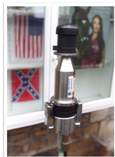
[Mesure des particules d'amiante]
